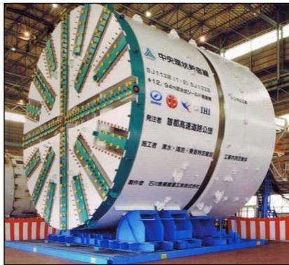
Abb. 17: Tunnelbohrmaschine
