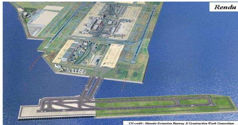
Abb. 3: Entwurf der D-Landebahn des Haneda Flughafens
