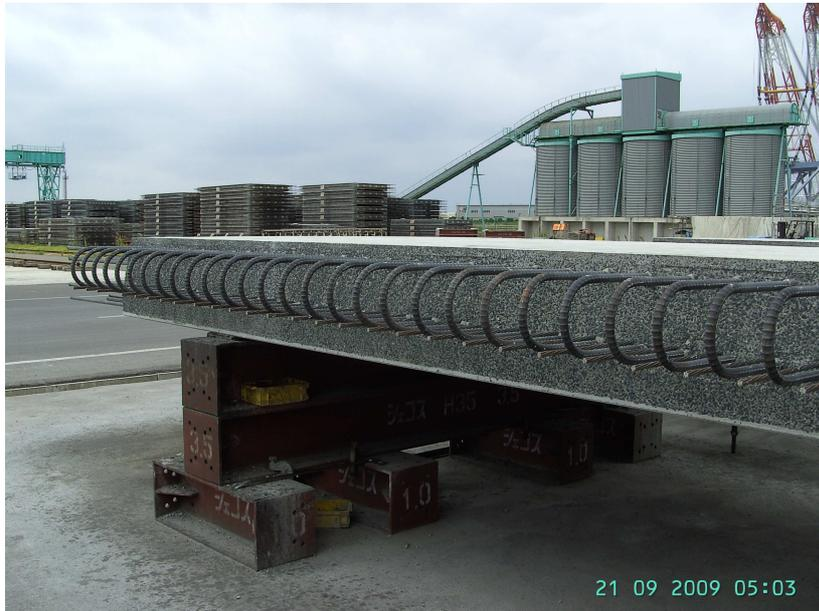
*Abb. 5: Vorgespanntes Betonfertigteile mit Anschlussbewehrung*
