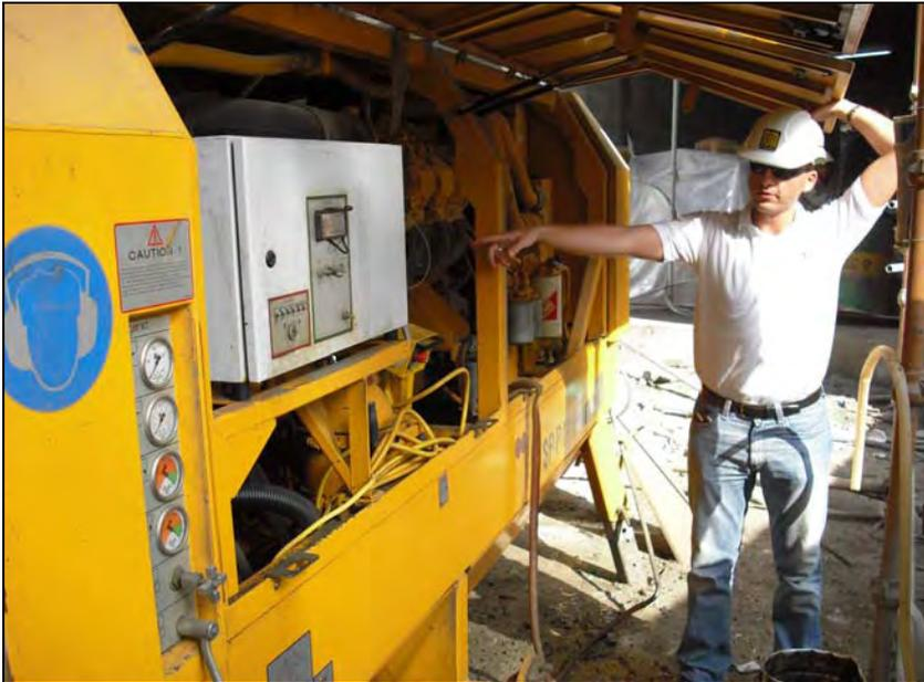
Abb. 26: Betonpumpe BWS 2110
