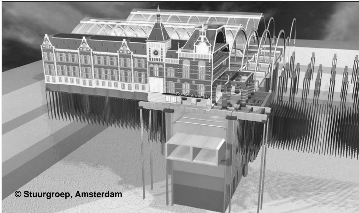
Bild 2: Die Sandwichwände und Pfähle unter dem Bahnhofsgebäude nach Fertigstellung
