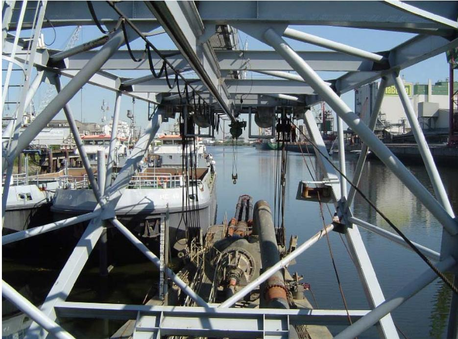
Von einem schwimmenden, durch Stelzen verankerten Ponton wird mittels Saugrohr, an dessen vorderem Ende ein rotierender Schneidkopf sitzt, Boden an der Gewässersohle gelöst. Das gelöste Gut wird durch das Rohr gesaugt und an Land oder in Schuten gespült.
