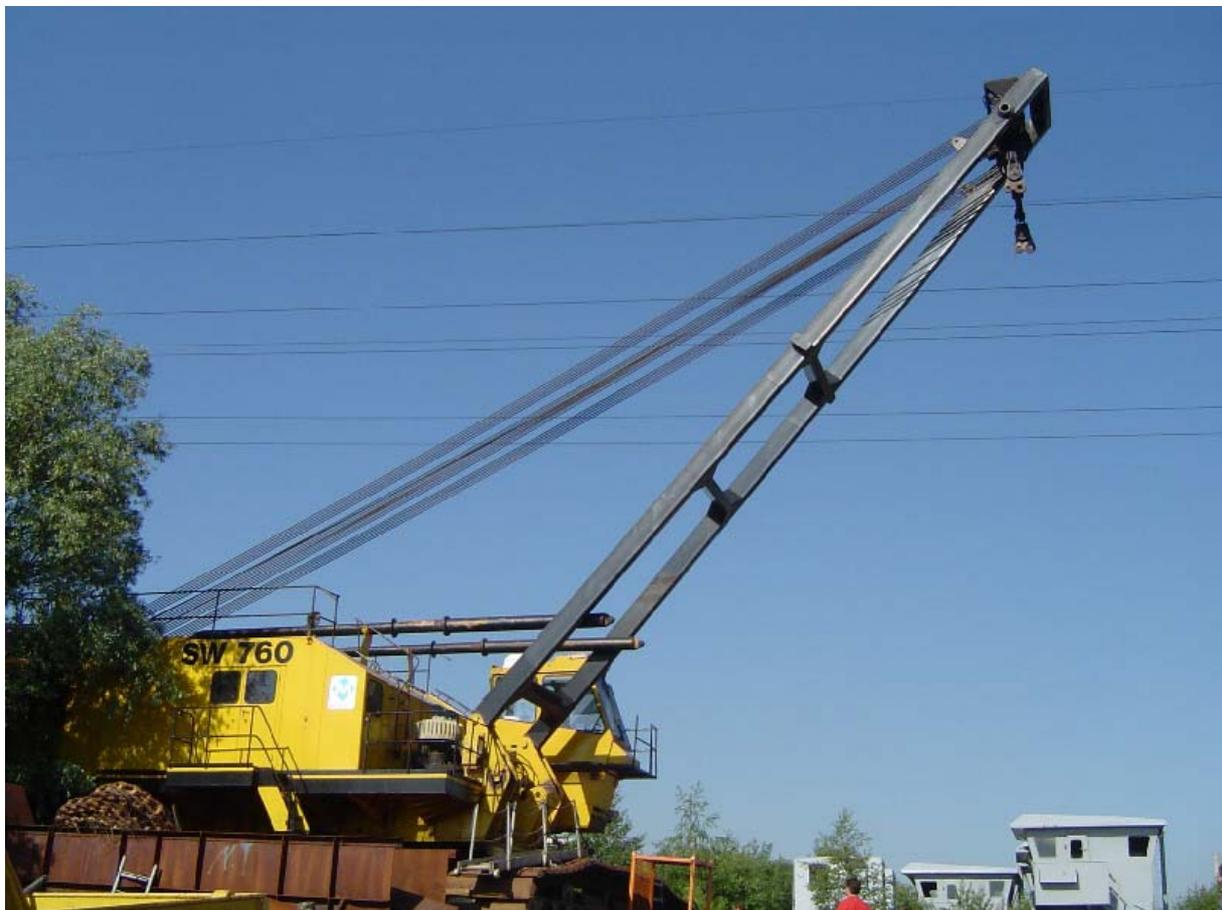
Dieser bis maximal 276 t schwere Bagger ist mit einem Greifer von 15 m<sup>3</sup> ausgestattet. Einer von nur fünf gebauten Baggern dieses Typs wurde lange Jahre von der Firma Möbius im Hamburger Hafen, auf einem Ponton verzurrt, eingesetzt. Verzurrt bedeutet, dass die Maschine nicht fest auf dem Ponton befestigt ist, sondern auf den eigenen Ketten steht.
