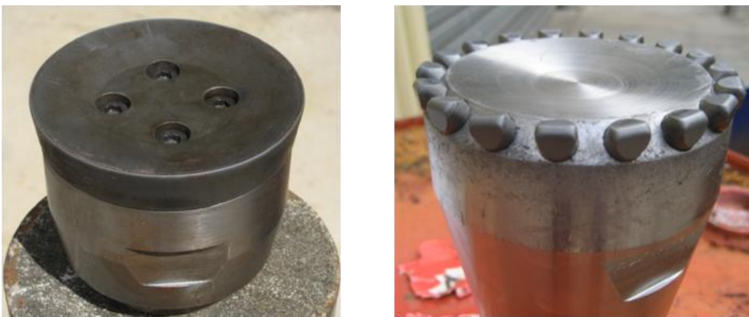
Abbildung 1: Hinterschneid-Diskens, links: Ring-Cutter, rechts: Button-Disk (Quelle: CRC Mining, AUS)
