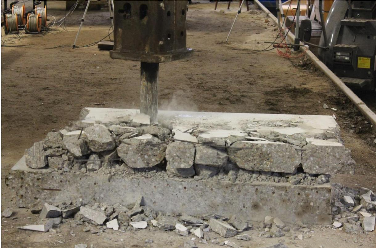
Abbildung 13: Dritte Versuchsreihe: Abbruch von Stahlbetonteilen
