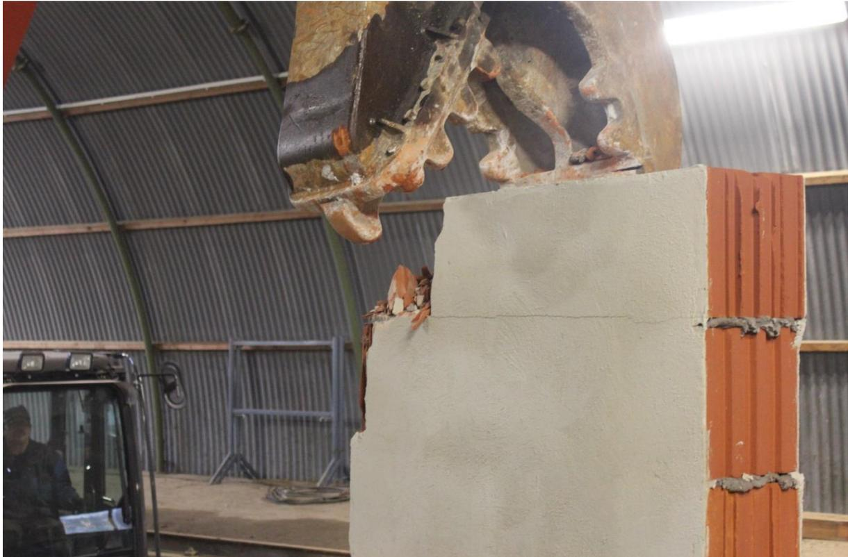
Abbildung 12: Zweite Versuchsreihe: Abbruch von verputzten Ziegelsteinwänden
