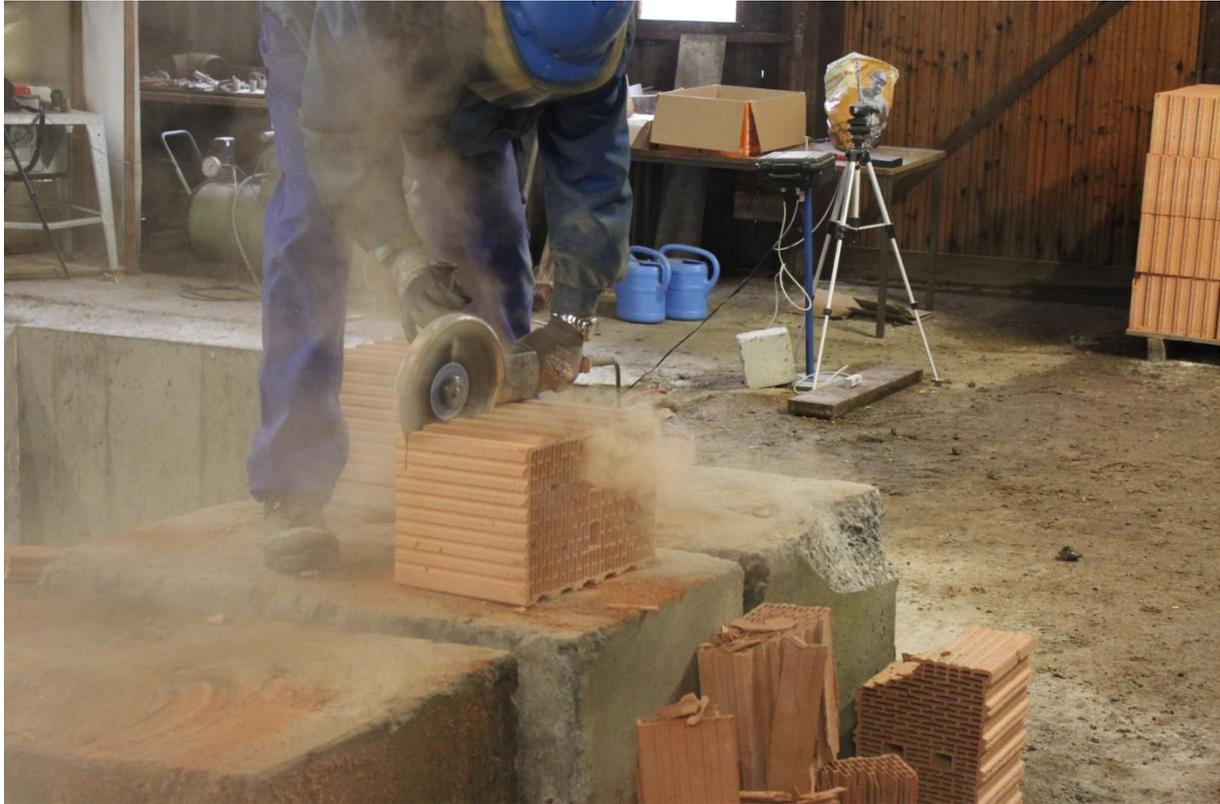
Abbildung 14: Erste Versuchsreihe: Sägen von Ziegelmauerwerk
