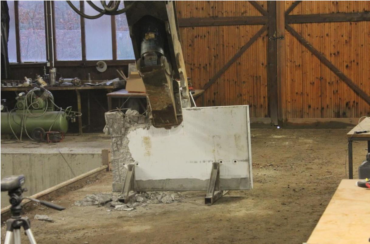
Abbildung 15: Dritte Versuchsreihe: Pressschneiden von Stahlbeton
