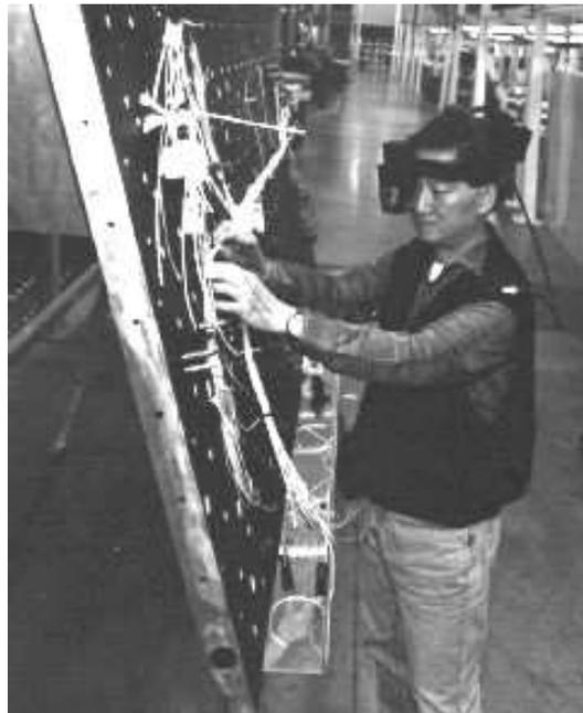
Abbildung 2.20: AR-basierte Herstellung von Kabelbäumen [420]
