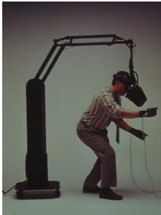
Abbildung A.5: Tracking mithilfe des „Boom-Devices“ [84]
