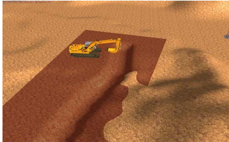
Abbildung A.10: Geo-Fencing: Arbeitsbereich des Ausbaugeräts
