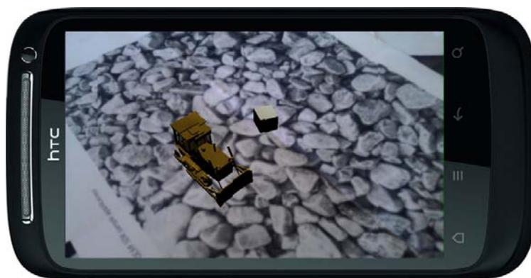
Abbildung A.12: Darstellung virtueller Baumaschinen via Smartphone-AR-Applikation
