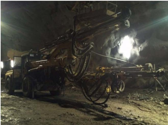
Abb. 2: Hydraulikbohrhammer zur Erstellung von Sprenglöchern
