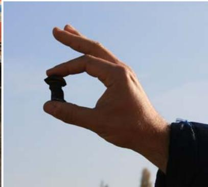
*Abb. 3: Originalniete, verformt durch hohe Kräfte*
