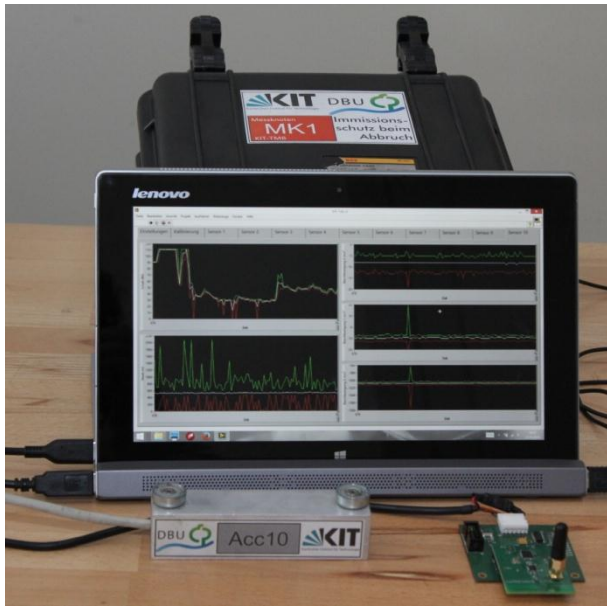
Abbildung 26: Messgraphen auf Tablett-PC, Beschleunigungssensor und Koordinator (ZigBee-Empfänger)
