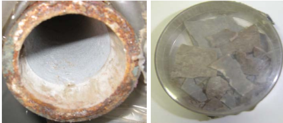
Fig. 1 und 2. Rohr nach Bearbeitung mittels mechanischem Verfahren, abgeplatzte Beschichtungsstücke nach der Bearbeitung
