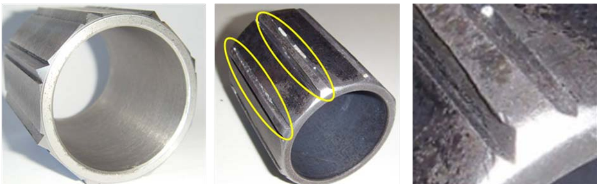
Fig. 10. Ausgangszustand und Verschleißerscheinungen am Dekontaminationswerkzeug
