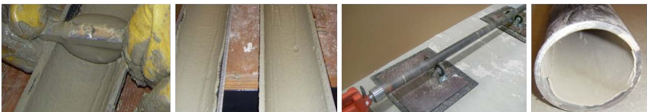
Fig. 12. Nachbilden der Ablagerungen in Rohr-Halbschalen
