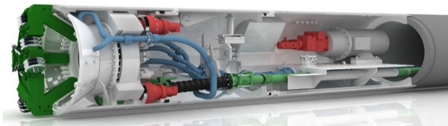
Abbildung 31: Schnitt durch AVN-Maschine 41
