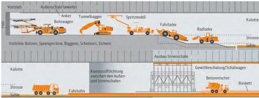
Abb. 3: Schematischer Aufbau des Tunnelvortriebverfahrens<sup>4</sup>
