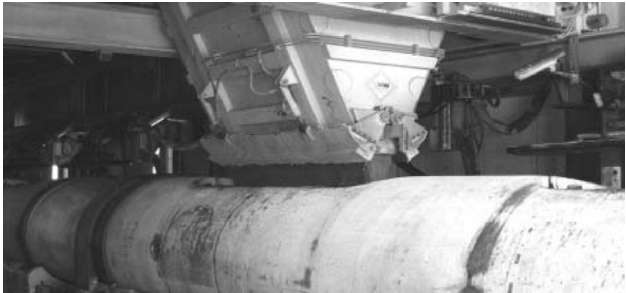
Befüllung einer Betonkapsel
