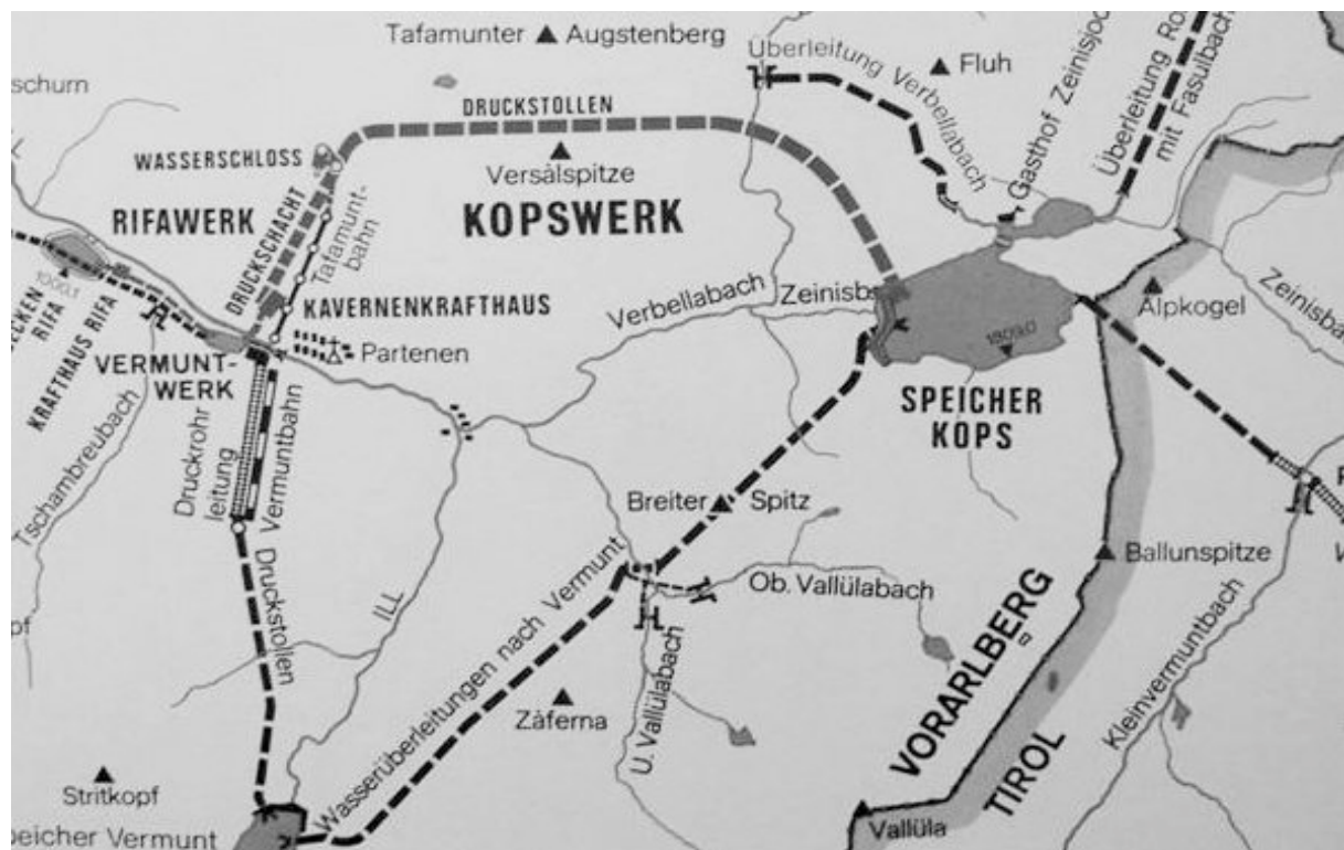
Druckstollen vom Kopssee über das Kopswerk zum Rifawerk
