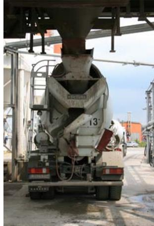
Abb. 5: Befüllung eines Mixers
