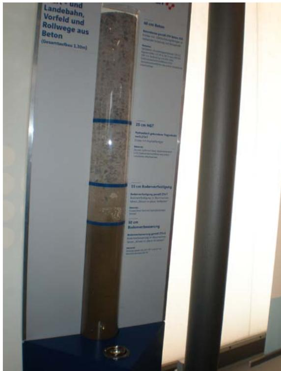
Abb. 4: Schichten der neuen Start- und Landebahn
