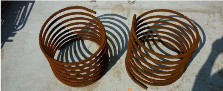
*Abb. 6: Bewehrung der Krafteinleitungspunkte der Spannlitzen in das BW<sup>7</sup>*
